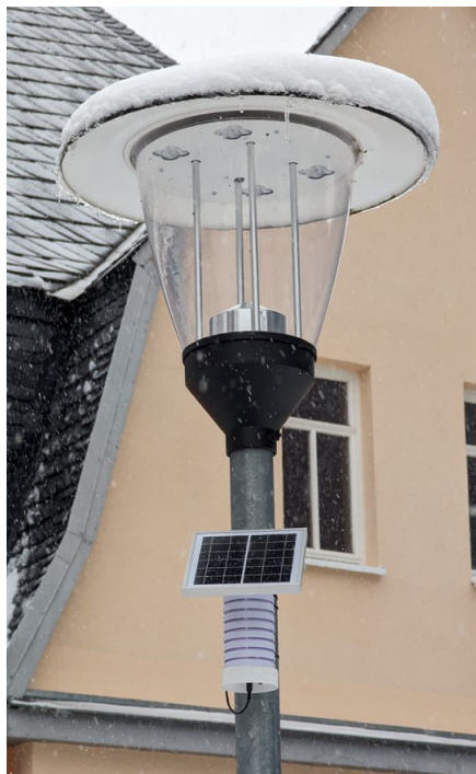
Abbildung 2: Sensor an einem Lichtmast am Kurpark in Stützerbach. Foto: Marco Götze, IMMS.
