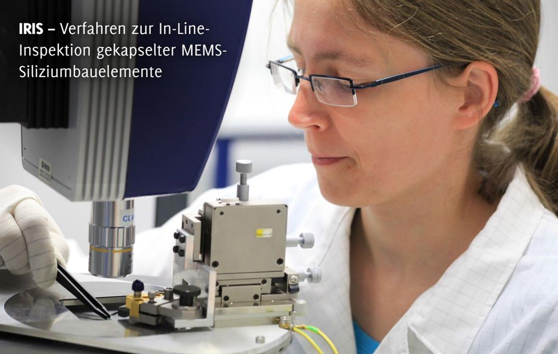
Vibrometrische Untersuchungen an gekapselten MEMS-Strukturen. Foto: IMMS.
