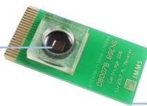
Cartridge als biokompatibles CMOS-Biochip-Gehäuse mit geklebtem, gebondetem und verkapseltem CMOS-Biochip
