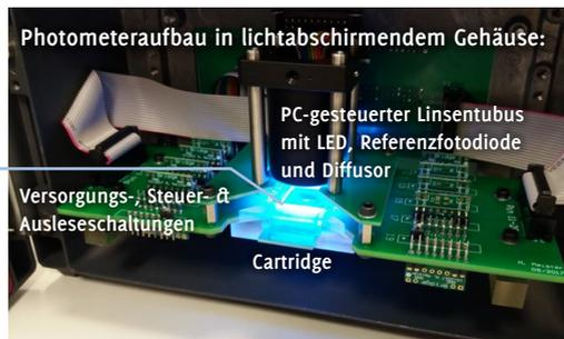
Photometeraufbau in lichtabschirmendem Gehäuse:
