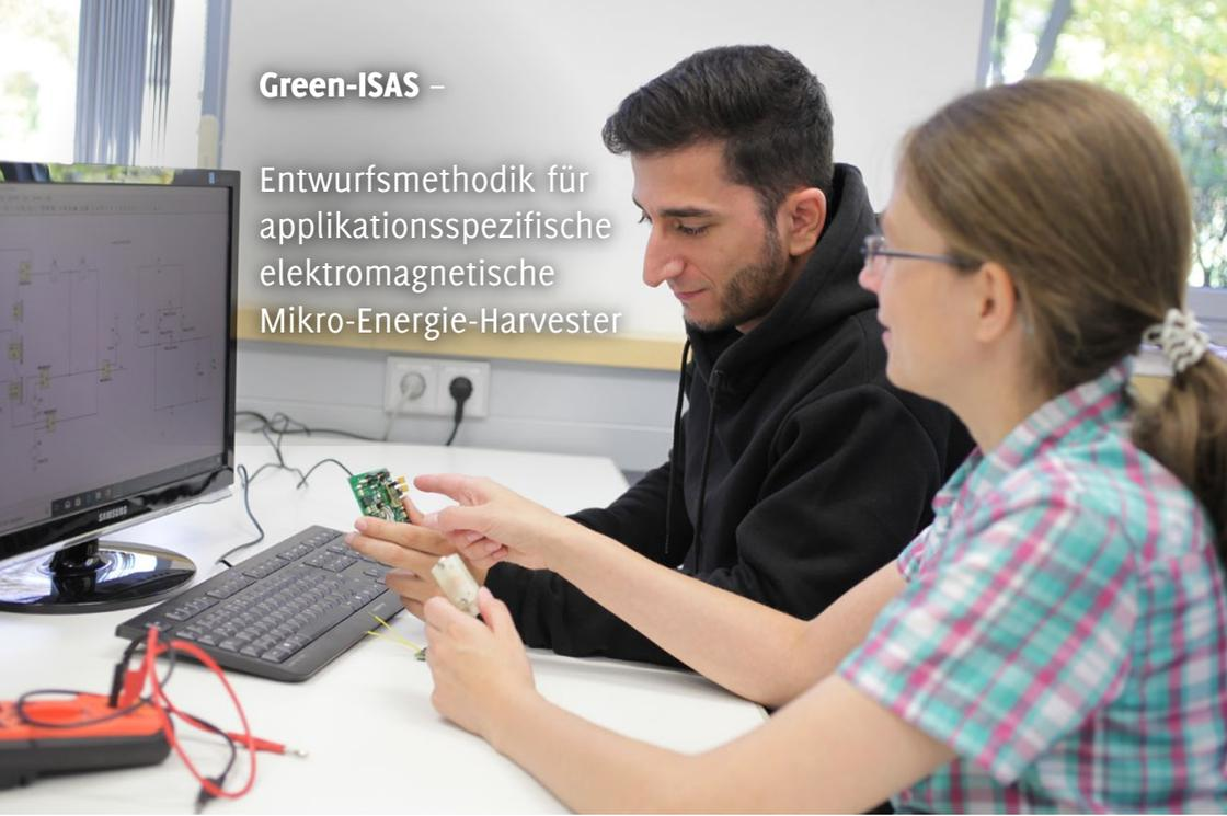
Arbeiten mit einem Evaluationsboard für elektromagnetische Mikro-Energie-Harvester, mit denen die am IMMS hierfür entwickelte Entwurfsmethodik verifiziert wurde. Foto: IMMS.
