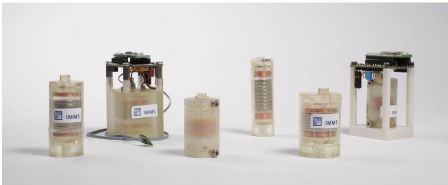
Abbildung 5: Auswahl gefertigter Demonstratoren (Aufbauten rechts und 2. v. links mit Frontend- und Funksensorschaltung). Foto: IMMS.
