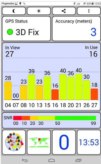
Abbildung 5. In einer abgeschirmten Messkammer des IMMS wurde die Qualität der Signalübertragung des Frontends zu einem handelsüblichen GPS-Gerät mit entsprechender App auf Android-Basis nachgewiesen: Es werden 16 Satelliten empfangen, deren Signale werden dekodiert und der Standort mit 3m Genauigkeit bestimmt. Grafik: IMMS.
