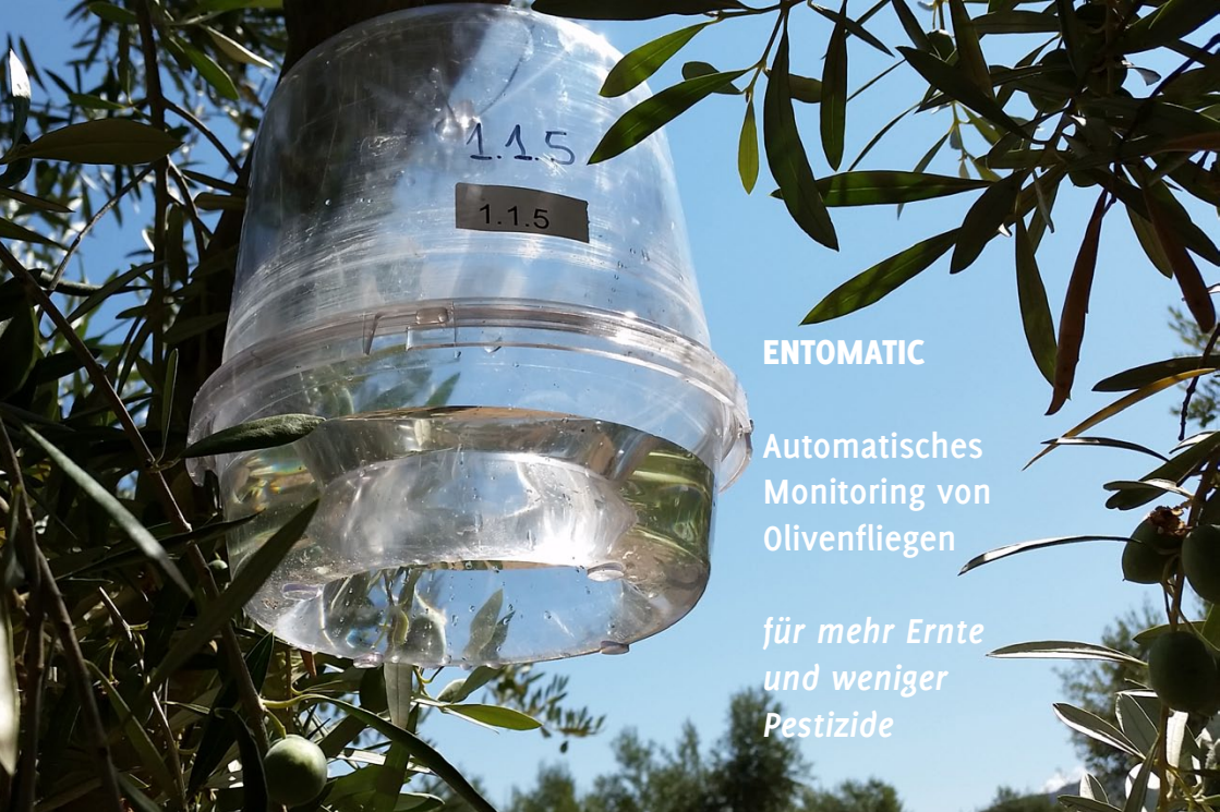
Abbildung 1: Insektenfallen wie diese vom Typ McPhail sind Teil eines Systems zum Monitoring von Olivenfliegen. Foto: Nutesca S.L., Spanien.
