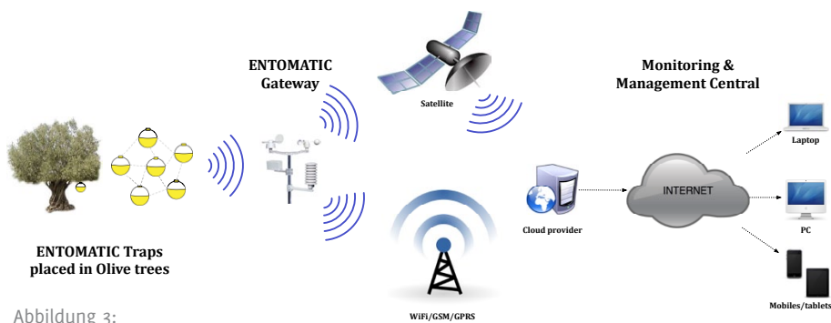
Abbildung 3: Funktionsprinzip für das vernetzte Monitoring von Olivenfliegen. Grafik: ENTOMATIC-Konsortium.
