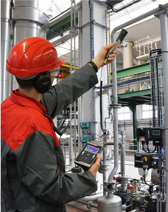
Das neuentwickelte Ultraschallmessgerät für die vorbeugende Instandhaltung im Einsatz. Das Gerät wurde auf der HANNOVER MESSE 2016 präsentiert. Bildrechte: fotolia: industrieblick/SONOTEC.
