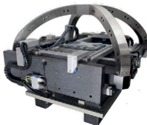
Bild 3: Luftgeführter 3D-Direktantrieb, Fahrbereich 400x400 mm 2 ; Quelle: IMMS 2009
