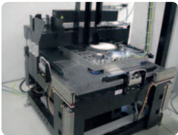
Abbildung 1: Testaufbau Planarantrieb mit Active Mount System
