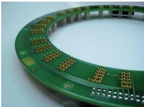
Abb. 1: Adaptierungsplatine mit Federkontakten
