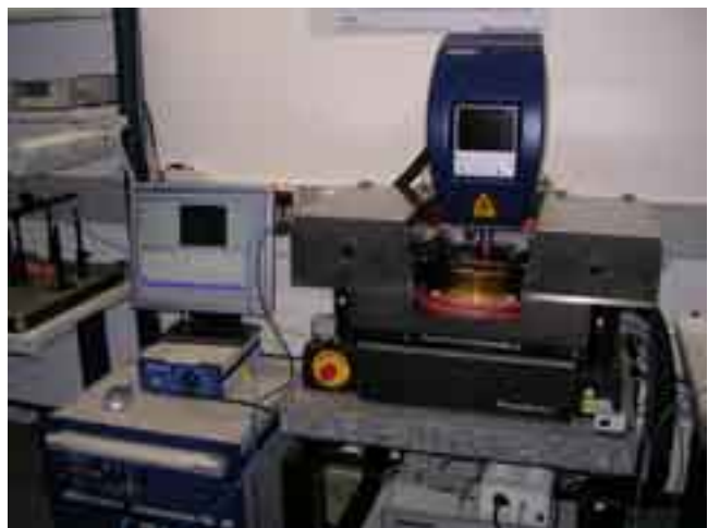
Abb. 1: Messsystem bestehend aus Prober, optischer Messeinheit und elektrostatischer Anregung
