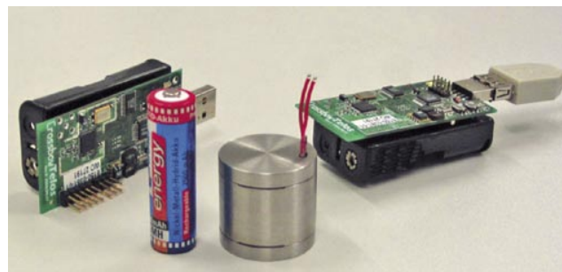
Abb. 1: Darstellung des elektromagnetischen Wandlers neben zwei der Nahbereichsfunkmodule, die vom Generator zur Datenübertragung gespeist wurden. Zum Größenvergleich ist ein konventioneller AA-Akkumulator gezeigt.
