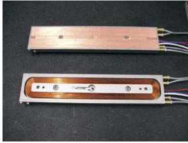
Abb. 2: Temperierung der Antriebsspulen
