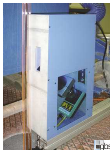
Abb. 1: Komponenten des visuellen Qualitätskontrollsystems und Einsatz im Wandstärkemessgerät WS 10
