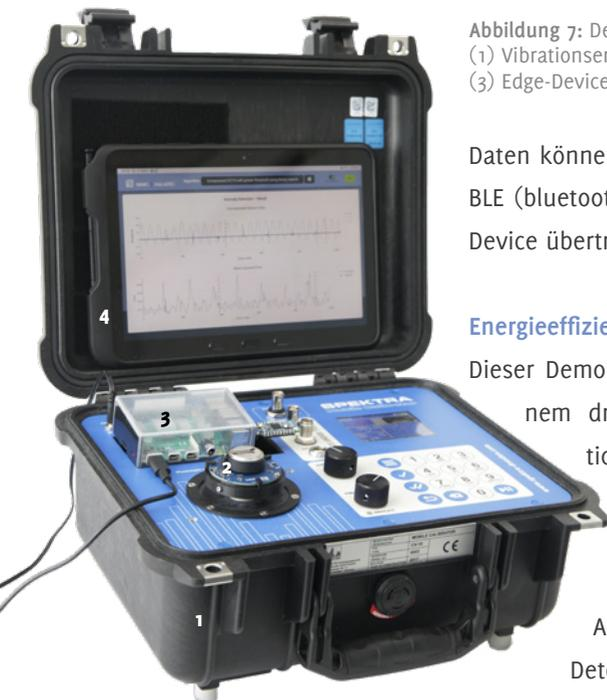
Abbildung 7: Demonstratorsystem mit (1) Vibrationserzeuger, (2) drahtlosen Sensorknoten, (3) Edge-Device und (4) Tablet. Foto: IMMS.
