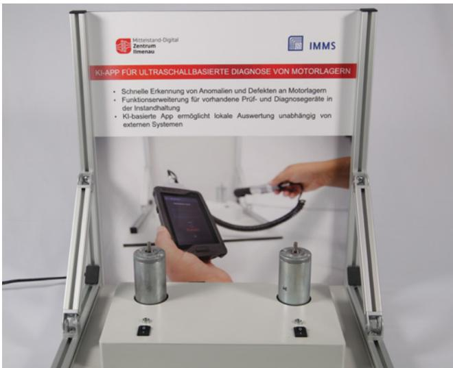
Am IMMS im Mittelstand-Digital-Zentrum Imenau entwickelter Demonstrator zur ultraschallbasierten Diagnose von Motorlagern mit einer KI-basierten Datenauswertung in einer App.
