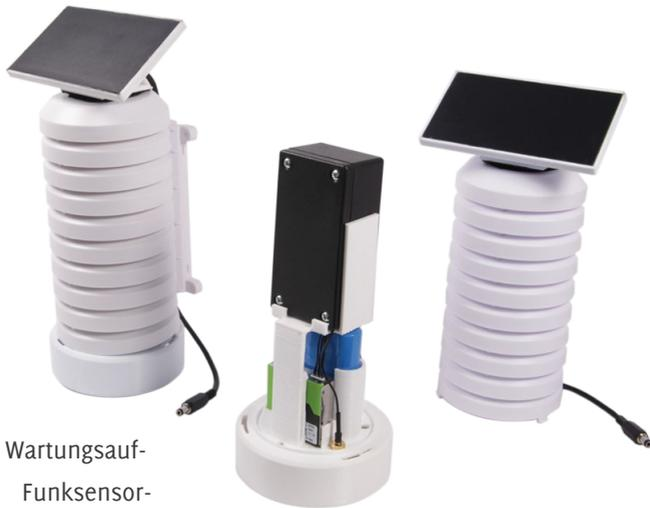
Zur Vermeidung von Wartungsaufwänden wurden die Funksensorknoten energieautark konzipiert: Über ein kleines Solarpanel laden sie eine Pufferbatterie, die ihnen auch über mehrwöchige Phasen mit wenig Sonnenschein hinweg einen Betrieb ermöglicht.
