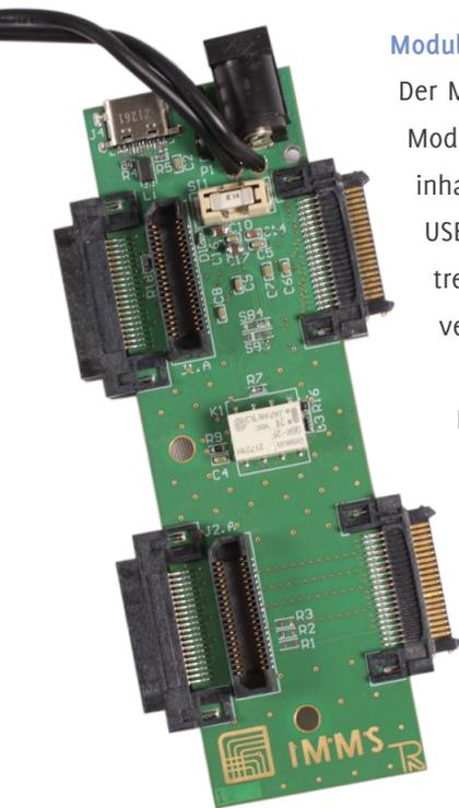
Abbildung 3: Standalone-Modul-Treiber für PTK-4.0- und AMS-ASIC-Scope-Module. Foto: IMMS.
