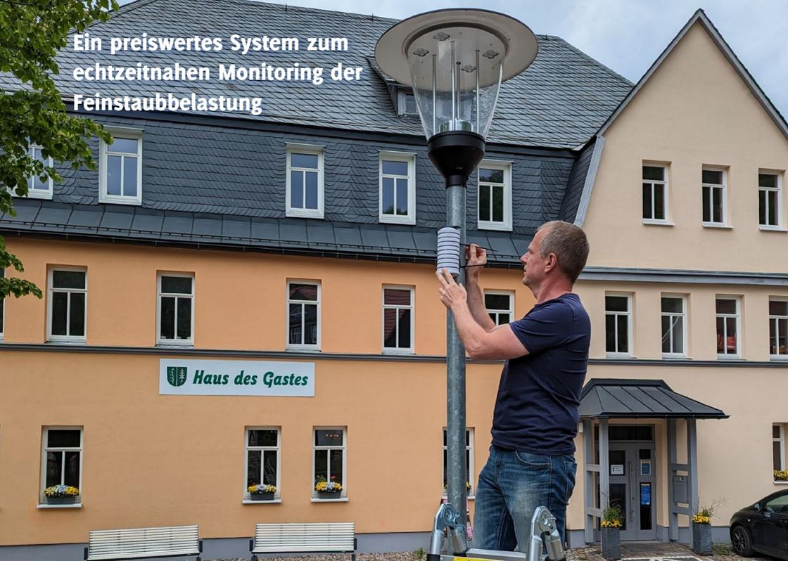
Das IMMS hat im Projekt thurAI ein kompaktes energieautarkes System für das kontinuierliche Feinstaubmonitoring entwickelt, das sich in bestehende Infrastruktur mit Low-Power-Weitbereichsfunktechnologie LoRaWAN einbinden lässt und das für Messungen in den Ilmenauer Ortsteilen und Urlaubsorten Frauenwald, Manebach und Stützerbach installiert wurde. Foto: Marco Götz, IMMS.
