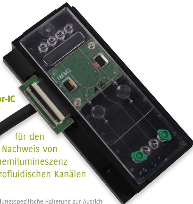
Das Bild zeigt die anwendungsspezifische Halterung zur Ausrichtung des Mikrofluidik-Chips direkt über dem Sensor-IC. Foto: IMMS.
