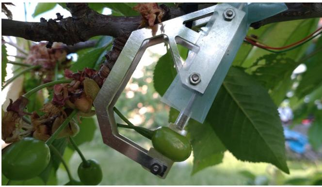
Am IMMS entwickelter Sensor zur Messung des Fruchtwachstums zur Optimierung von Bewässerungsmaßnahmen. Solche und weitere Sensoren werden Teil des digitalen Zwilling, den das IMMS im Projekt MIRO erarbeiten wird. Foto: IMMS.
