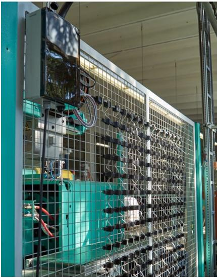
Bei der eitech GmbH installierter Sensorvorhang und Mini-PC als Datensammler zur kontinuierlichen Erfassung von Umweltbedingungen in der Fertigung. Foto: eitech GmbH.
