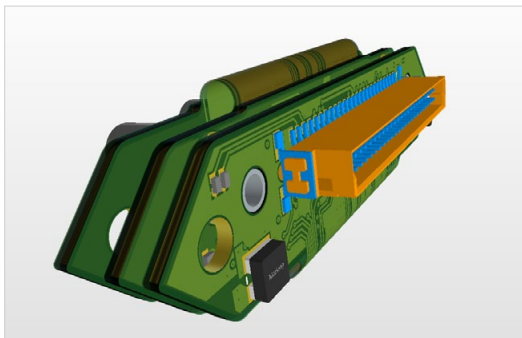
Abbildung 1: 3D-Darstellung der dreikanaligen Erweiterungsplatine für das SONAPHONE® und realisierte Hardware. Grafik: IMMS, Foto: SONOTEC.
