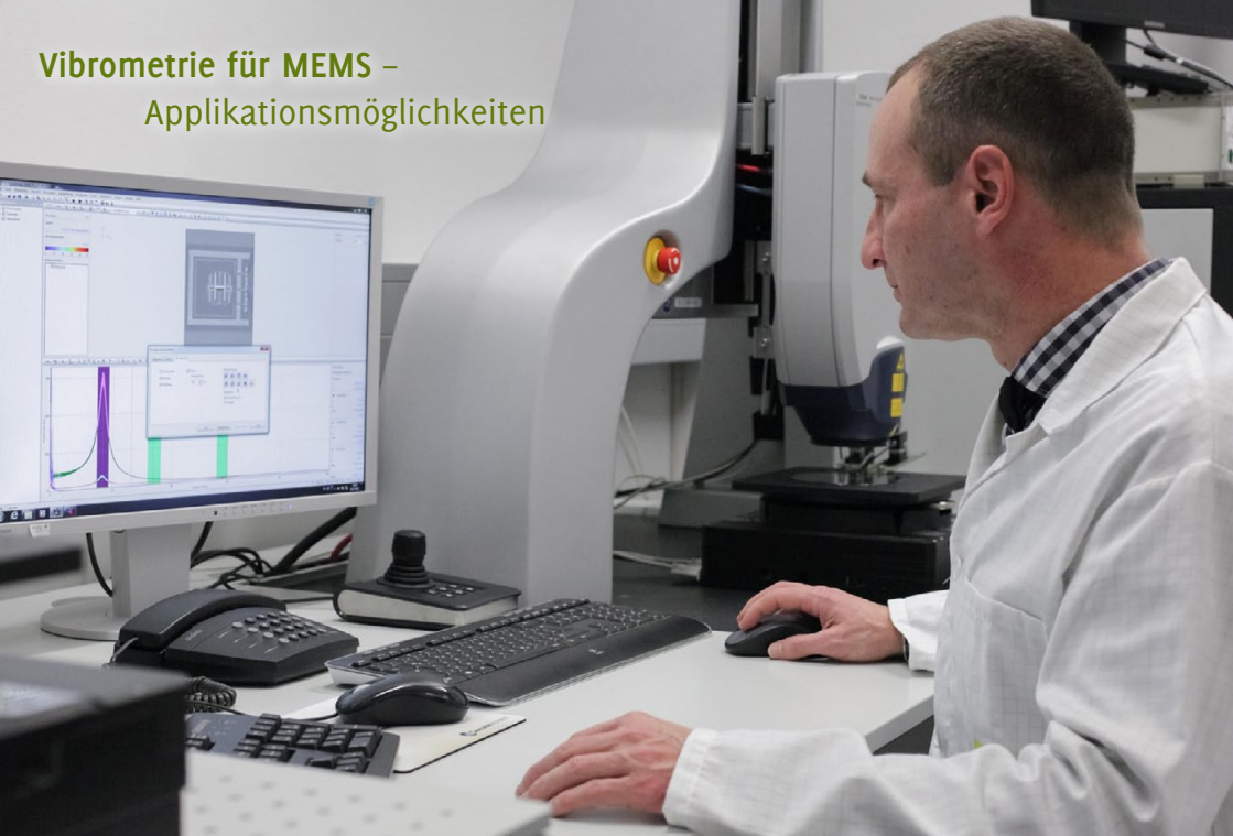
Messplatz zur Erfassung von 3D-Schwingungen an MEMS. Foto: IMMS.
