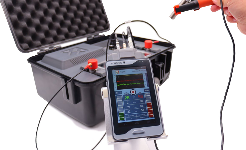
Abbildung 3: Mehrkanaliges Prüfgerät mit zwei Ultraschallsensoren und einem Drehzahlsensor am Lagerdemonstrator. Foto: SONOTEC.
