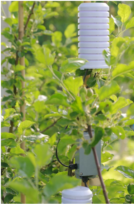
Vernetzte Sensorsysteme im Obstanbau: Damit lassen sich Maßnahmen für Pflege und Bewässerung besser planen sowie Ertrag und Qualität trotz klimatischer Veränderungen aufrechterhalten bzw. erhöhen. Foto: IMMS.
