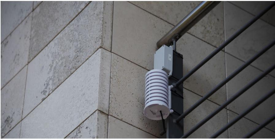
Mit installierten Funksensorknoten wie diesem am/im Newtonbau erhebt das IMMS über einen Gebäudekomplex am Campus der TU Ilmenau verteilt mikroklimatische Daten für Energieverbrauchsoptimierungen. Die zylindrische Einhausung schützt die Sensorik vor Aufheizeffekten durch direkte Sonneneinstrahlung. Foto: IMMS.
