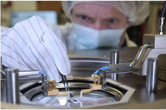
Voruntersuchungen am IMMS am Sensor der FSU Jena mit 15 Graphen-FETs für die miniaturisierte Messtechnik zum SARS-CoV-2 Nachweis. Foto: IMMS.
