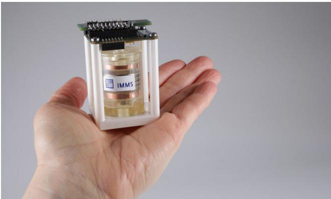
Demonstrator für elektromagnetische Energy-Harvester, für die das IMMS bereits in einem Vorprojekt eine Entwurfsmethodik für die Mechanik entwickelt und mit Demonstratoren verifiziert hatte. Im Projekt ECo-Harvester werden Mechanik und Elektronik gemeinsam entworfen.
