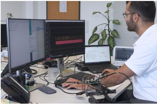
Voruntersuchungen für einen UHF-RFID-Sensor-Transponder-IC zur Überwachung von Pflanzen in Gewächshäusern und für einen Wake-Up-Empfänger-IC zum Monitoring von Windkraftanlagen, die das IMMS im Projekt StorAlge entwickelt. Foto: IMMS.
