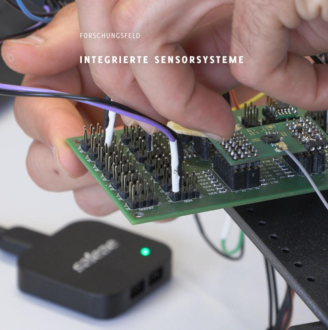
Voruntersuchungen für einen UHF-RFID-Sensor-Transponder-IC zur Überwachung von Pflanzen in Gewächshäusern und für einen Wake-Up-Empfänger-IC zum Monitoring von Windkraftanlagen. Diese ICs entwickelt das IMMS im Projekt StorAlge. Foto: IMMS.
