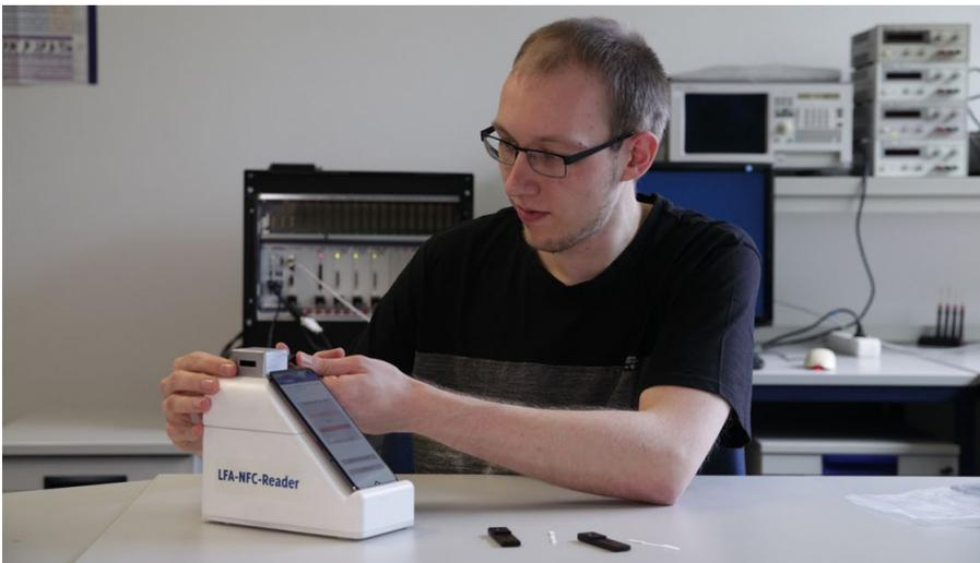
Markus Ismer mit seinem Demonstrator zum energieautarken Auslesen von LFA-Teststreifen per NFC. Foto: IMMS.
