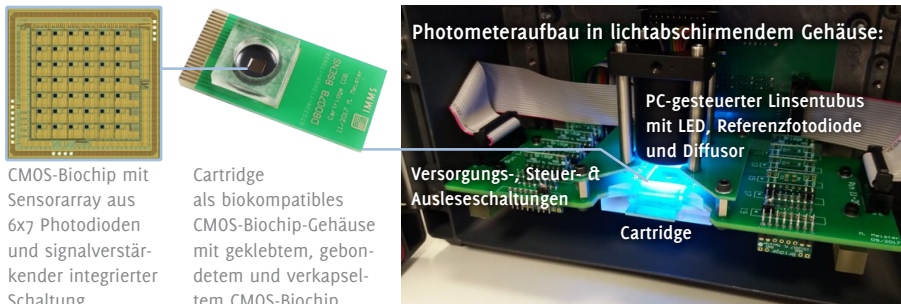
Abbildung 2: Der opto-elektronische CMOS-Biochip (links) lässt sich dank der Cartridge-Lösung (Mitte) auswechseln und im Photometeraufbau (rechts) für Messungen nutzen. Fotos: IMMS.
