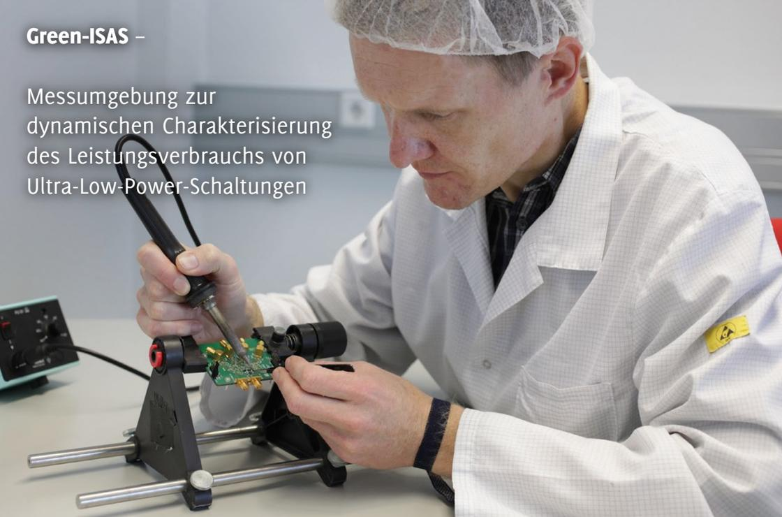
Arbeiten für eine Messschaltung, die das IMMS entwickelt hat, um Ultra-Low-Power-Schaltungen dynamisch charakterisieren zu können. Mit diesen ULP-Schaltungen können vernetzte integrierte Sensorsysteme energieautark arbeiten. Foto: IMMS.
