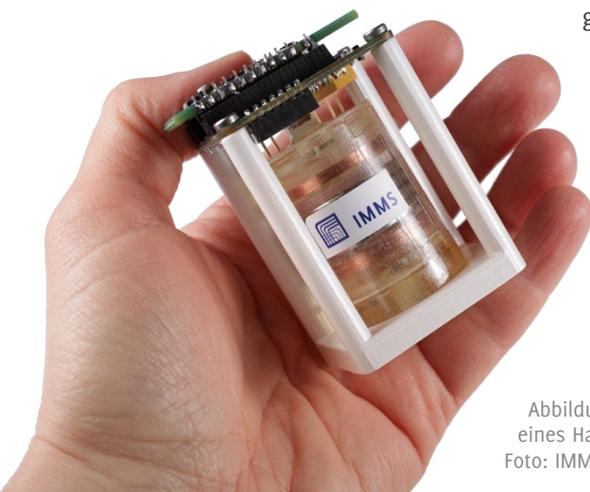
Abbildung 4: Kompakter Demonstratoraufbau eines Harvester-betriebenen Funksensors.
