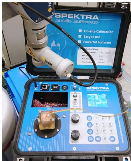
Abbildung 6: Messaufbau zur Charakterisierung der Energie-Harvester mittels Shaker und Vibrometer. Foto: IMMS.
