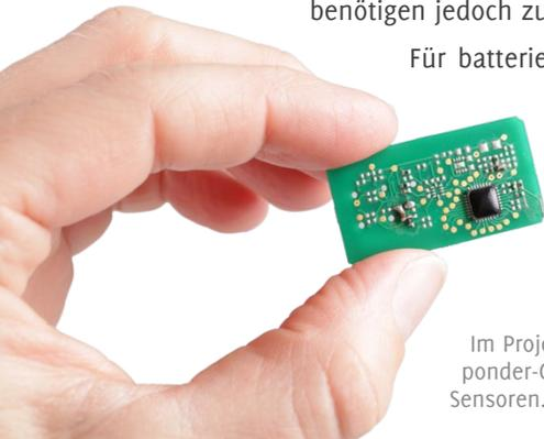
Im Projekt ADMONT\* vom IMMS entwickelter RFID-Transponder-Chip zum batterielosen Betrieb kommerzieller Sensoren. Foto: IMMS.
