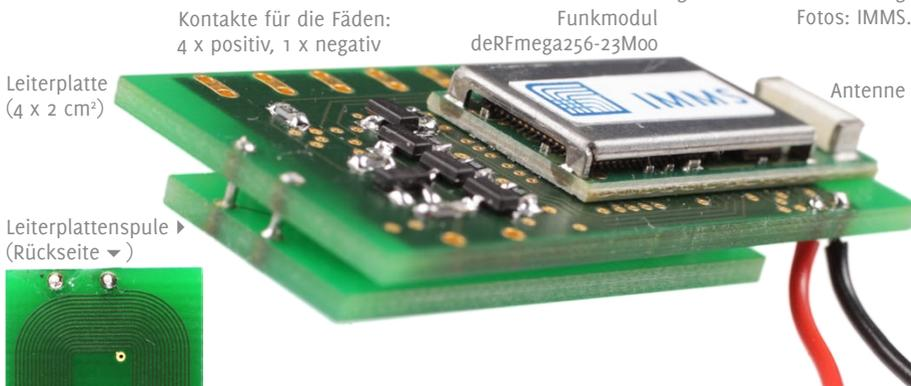
chen Reichweitentests mit einem NFC-Lesegerät wurde eine geeignete Leiterplatten-spule bestimmt. Mit diesem Spulenmodell wurden ebenfalls die Empfänger ausge-rüstet, damit sie per NFC erfasst und den Stricktastern zugeordnet werden können. Zum Anschluss der gestrickten Schaltflächen und zusätzlich notwendiger Sensorik sind auf der Leiterplatte Schnittstellen wie ADC und I<sup>2</sup>C verfügbar.
