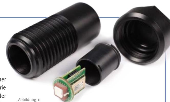
Abbildung 1: Detektor-Elektronik und -Einbauhülse (7 cm Durchmesser, 12 cm Tiefe). Die Verkehrsdetektoren sind kompakte eingebettete Systeme aus einer optimierten Elektronik und einer Batterie, die in einem Kunststoffgehäuse in ein Bohrloch in der Straßendecke mit geringem Aufwand installiert werden. Foto: IMMS.
