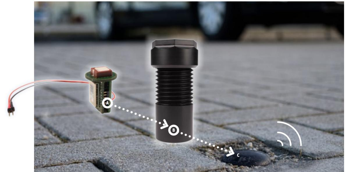
Abbildung 1: Vom IMMS entwickelte Detektor-Elektronik (A), die in der Sensorhülse (B) in der „taktile Straße“ (C) eingebaut wird. Fotos: IMMS.
