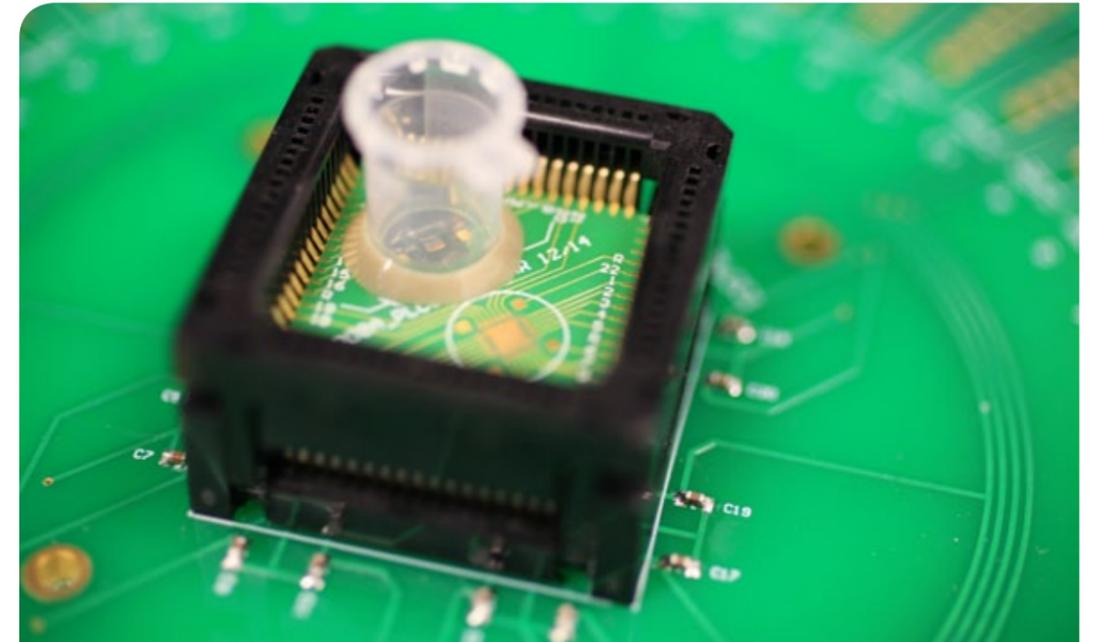
Testaufbau für den im Projekt GreenSense entwickelten RFID-Multisensor-ASIC zur Analyse wässriger Lösungen. Foto: IMMS.
