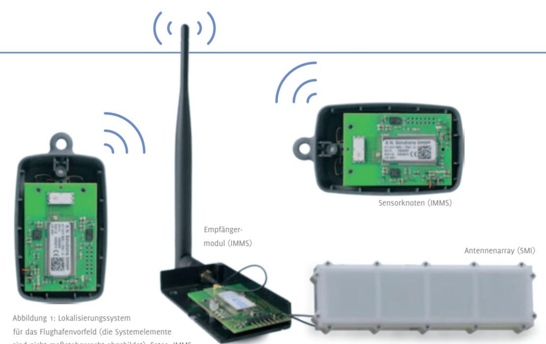
Abbildung 1: Lokalisierungssystem für das Flughafenvorfeld (die Systemelemente sind nicht maßstabgerecht abgebildet). Fotos: IMMS.
