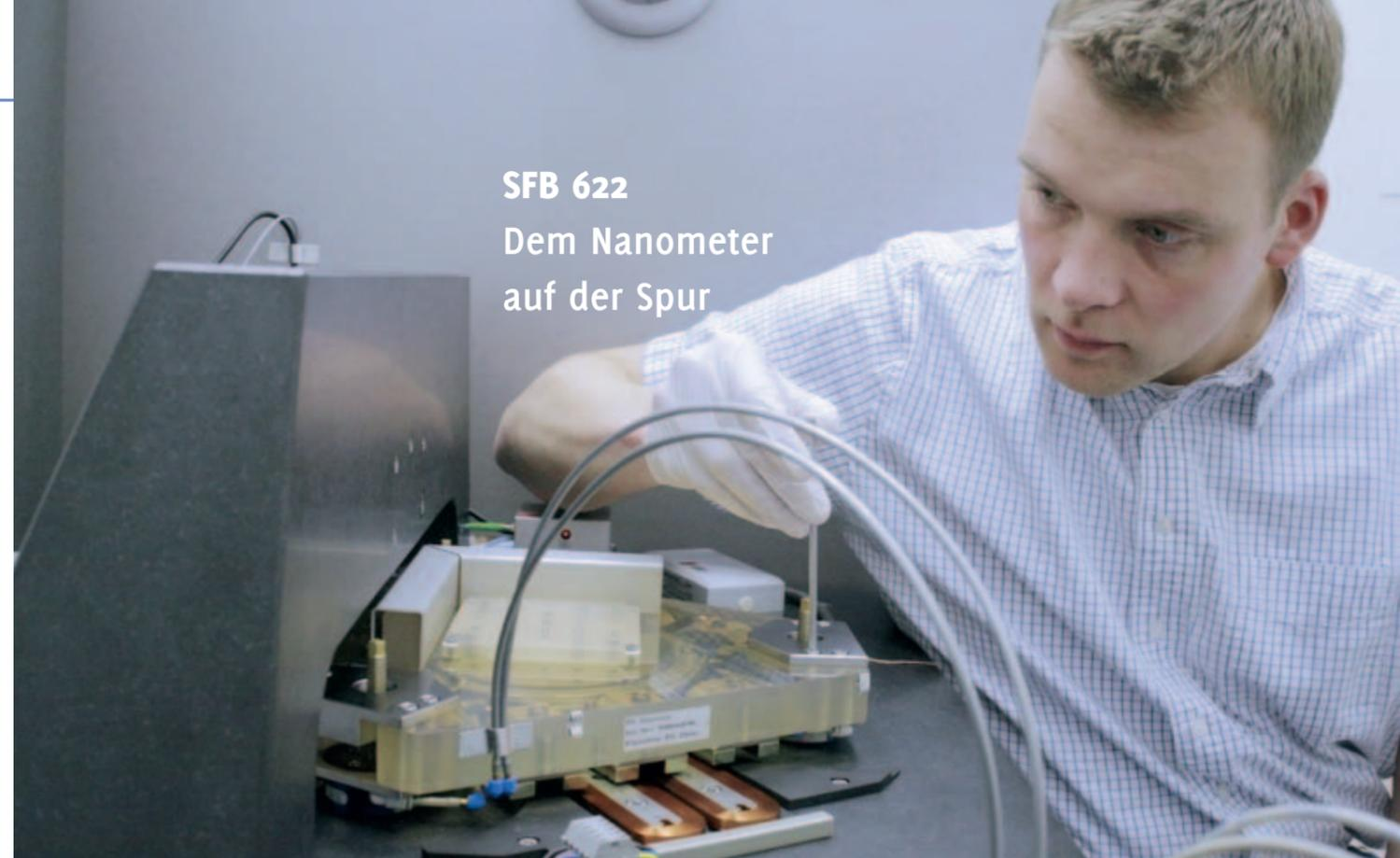
Bild 1: Das IMMS hat in den SFB 622 v.a. sein Know-how zu integrierten Mehrkoordinatenantrieben in die Entwicklung von Nanopositioniersystemen eingebracht, wie für das abgebildete PMS100. Foto: IMMS.
