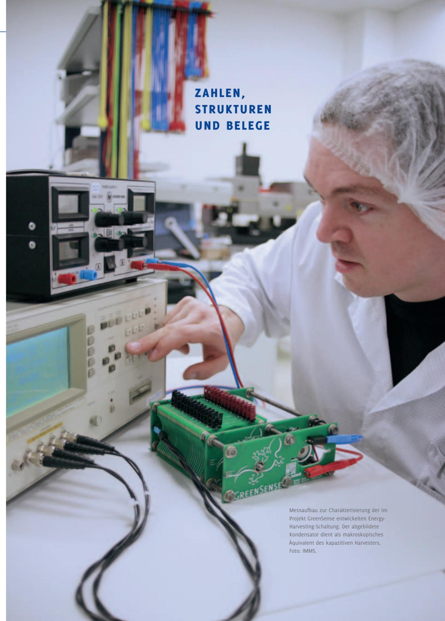
Messaufbau zur Charakterisierung der im Projekt GreenSense entwickelten Energy-Harvesting-Schaltung. Der abgebildete Kondensator dient als makroskopisches Äquivalent des kapazitiven Harvesters. Foto: IMMS.
