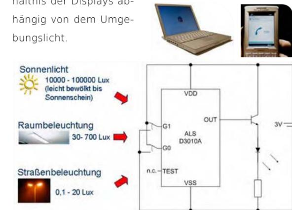
Abbildung 2: Anwendung des ALS D3010A
