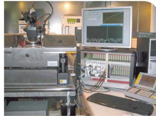
Anwendung: On-Wafer-Test mit automatischer Probersteuerung.
