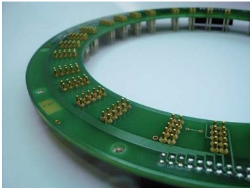
Abb. 1: Adaptierungsplatine mit Federkontakten
