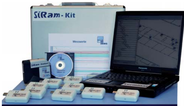
Abb. 1: Zusammensetzung des SiRaM-Kits: mobiler Einsatz-PC mit Software zur Sensordatenerfassung und Nahbereichsfunkknoten mit Sensoren zur Zustandsüberwachung.
