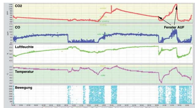
Abb. 4: Raumklimamessungen in einem Besprechungsraum. Dargestellt sind mehrere Raumklimaparameter über einem mehrtägigen Nutzungsintervall. Fig. 4: Measurements of ambient conditions in seminar room. Several ambient parameters are displayed for a multi-day usage interval.
