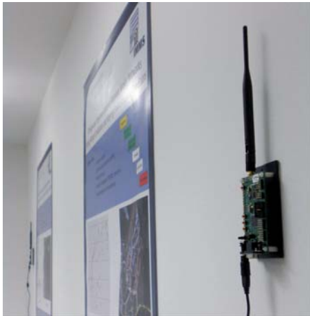
Abb. 6: Versuchsaufbau zur Evaluierung des nanoLOC Lokalisierungssystems in Gebäudeumgebungen
