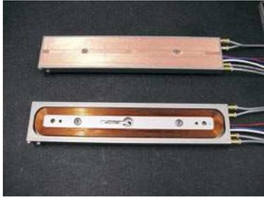
**Abb. 2:** Temperierung der Antriebsspulen
