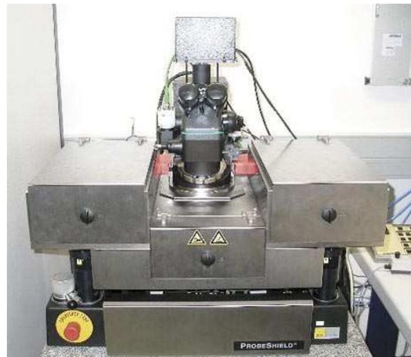
**Abb. 2:** Prober PA200 mit Scaneinheit
