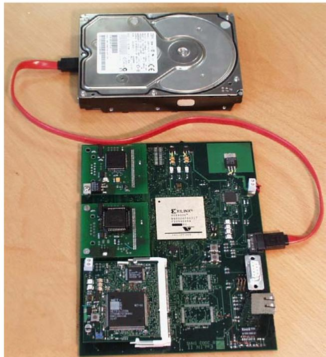
**Abb. 3:** Demonstrator mit simulierter Serial-ATA-Festplatte
