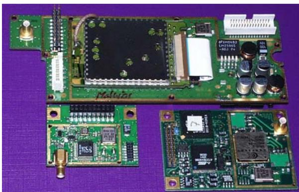
Abb. 3: Realisierte GPS/GSM-Boards
