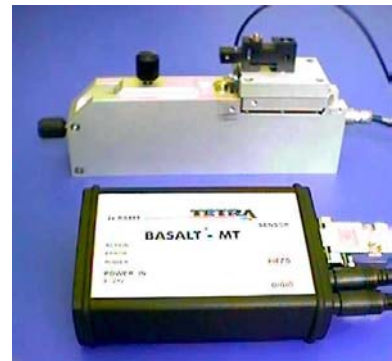
Abb. 2: Mikrotribometer für die Probenpaarung Fläche / Fläche
