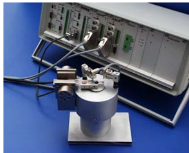
Abb. 1: Mikrotribometer für die Probenpaarung Fläche / Fläche
