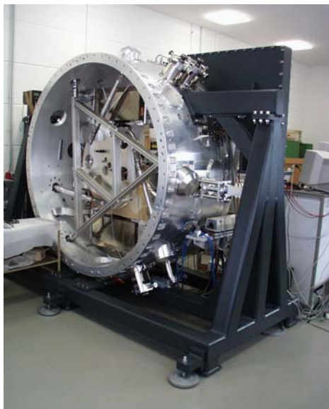
Abb. 2: Segment der Vakuumkammer mit dem Wafertisch
