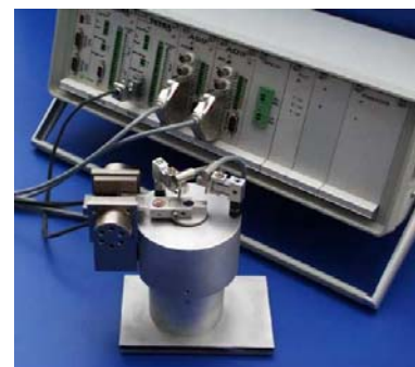
Abb. 3: Versuchsanordnung - Mikrotribometer für Probekörperpaarungen Fläche / Fläche
