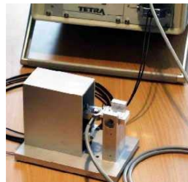
Abb. 2: Versuchsanordnung - Mikrotribometer für Probekörperpaarungen Kugel / Fläche
