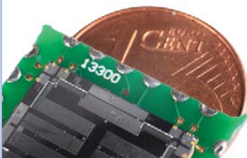
Beispiel eines MEMS-Harvesters für die autarke Energieversorgung von Mikro-Sensorsystemen.
