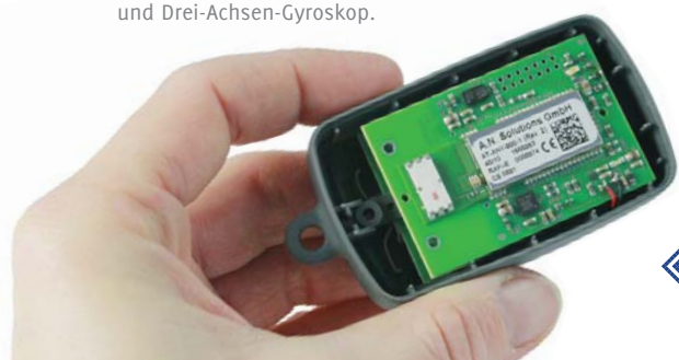
Beispiel für einen energieoptimierten Sensorknoten zur Lokalisierung von Personen auf dem Flughafenvorfeld. Das System enthält eine inertielle Messeinheit aus 3D-Magnetometer, Beschleunigungssensor und Drei-Achsen-Gyroskop.
