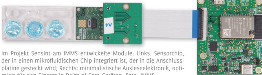
Im Projekt SensInt am IMMS entwickelte Module: Links: Sensorchip, der in einen mikrofluidischen Chip integriert ist, der in die Anschlussplatine gesteckt wird; Rechts: minimalistische Ausleseelektronik, optimiert für den Einsatz in Point-of-Care-Geräten. Foto: IMMS.
