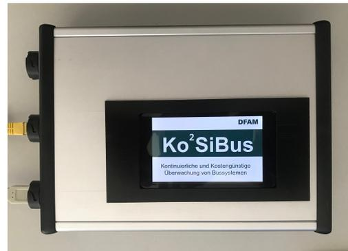
Abbildung 51: Gehäuseintegration des Analysegeräts
