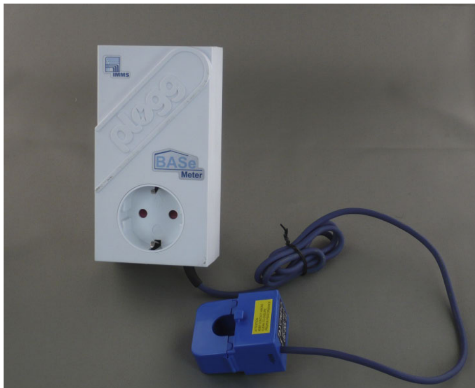
Abbildung 10: Sensorknoten BAsE-Meter zur Erfassung von Energieverbrauchsdaten.
