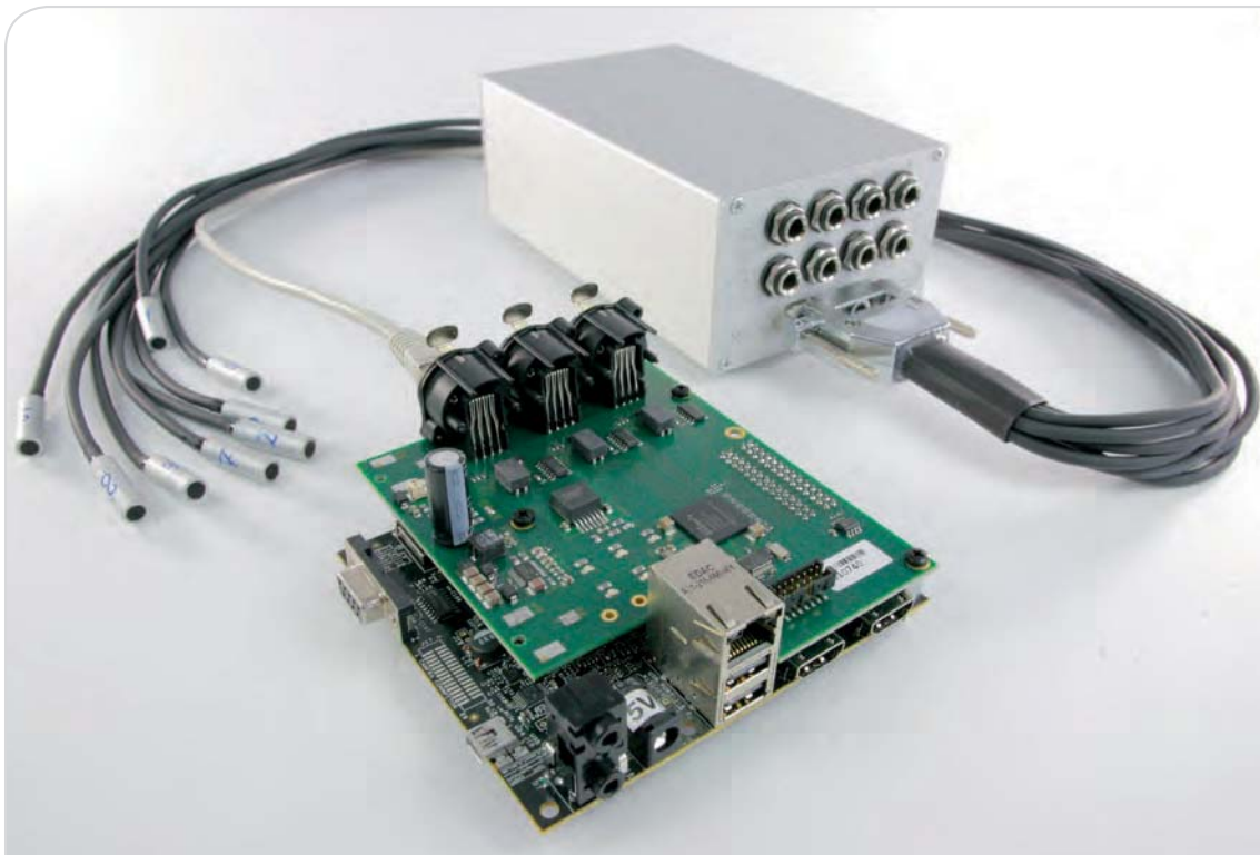
„S4ECoB“-System aus Mikrofonarray und eingebetteter energieeffizienter Hard- und Softwareplattform. Das System kann auf Basis akustischer Daten die Anzahl von Personen in Gebäudebereichen erfassen und abhängig davon die Haustechnik regeln. Foto: IMMS.
