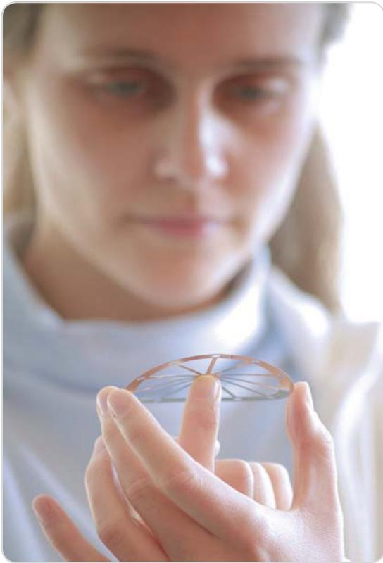
Bild 3: Die vertikale Präzisionsbewegung der SMART-Pixel-Kamera wird durch drei am Rand eingespannte Membranfedern stabilisiert. Quelle: IMMS
