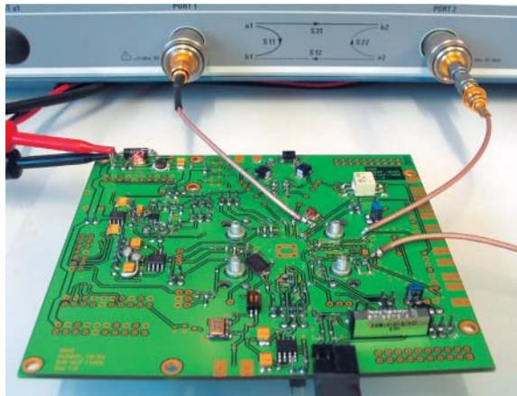
Abb. 1: Evaluationboard für HF-ASIC am NWA
