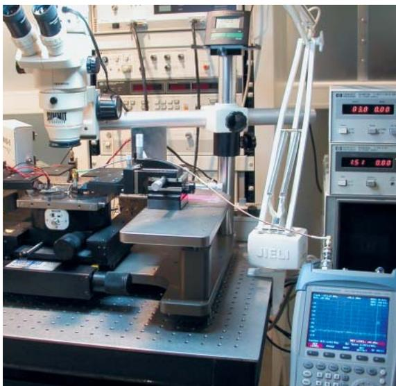
Abb. 3: Waferprober im abgeschirmten Raum
