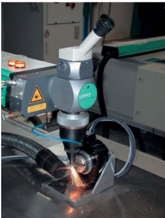
Abb. 1: 4D-System mit Laser
