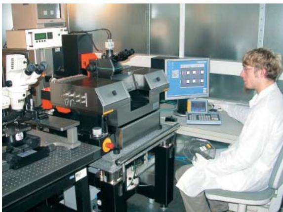
Abb. 1: halbautomatischer Waferprober PA200 in geschirmter Kabine
