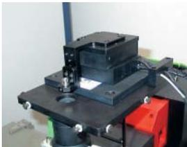
Abb. 1: Kreuztisch am PA200 mit Lichtwellenleiterkupplung
