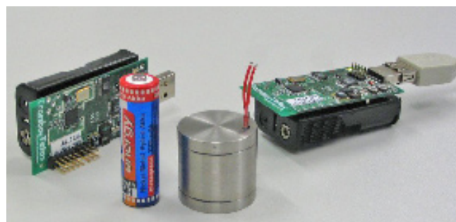
Abb. 1: Darstellung des elektromagnetischen Wandlers neben zwei der Nahbereichsfunkmodule, die vom Generator zur Datenübertragung gespeist wurden. Zum Größenvergleich ist ein konventioneller AA-Akkumulator gezeigt.
